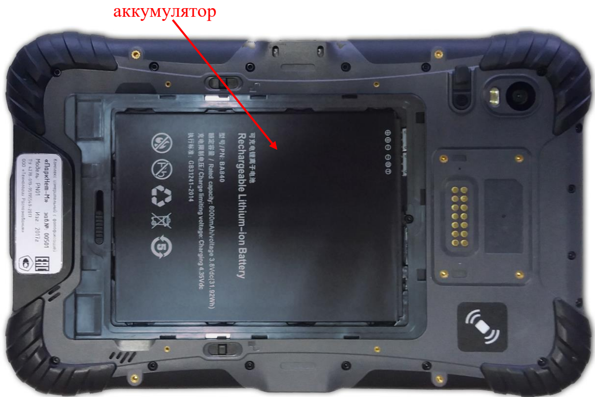
Рисунок 1.3 – Фотофиксатор (вид сзади, открыт аккумуляторный отсек)
