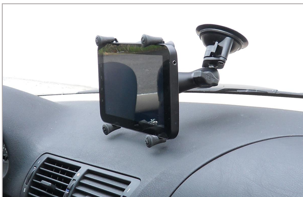
Рисунок 2.17 – Фотофиксатор на кронштейне, установка на лобовое стекло автомобиля
