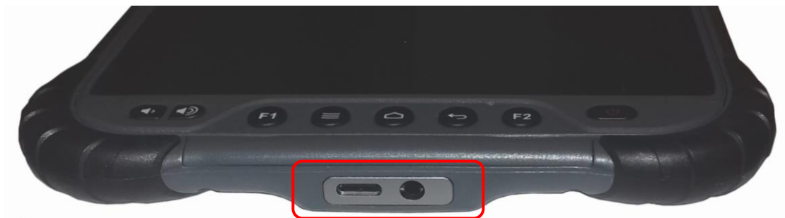
Рисунок 1.4 – Фотофиксатор (вид справа, разъем для подключения зарядного устройства)
