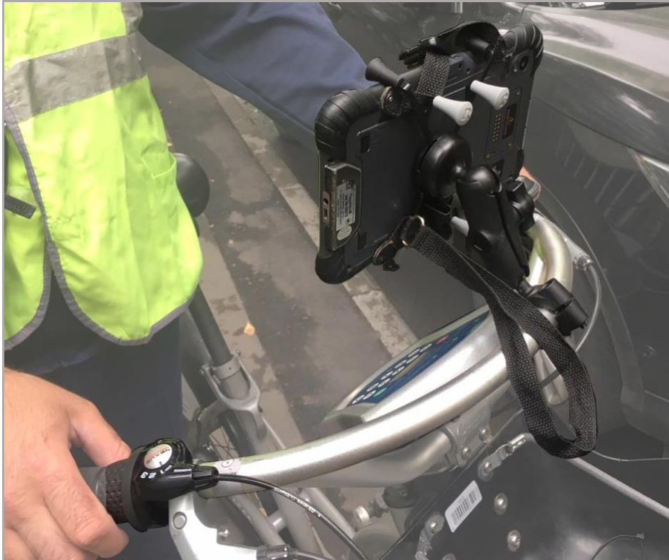
Рисунок 2.18 – Фотофиксатор на кронштейне, установка на руль велосипеда
